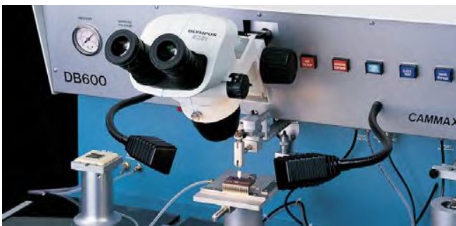
① B & L style bonder arm / SZ2-STB1 ② Bonder arm / SZ2-STB2 ③ Bonder arm / SZ2-STB3 ④ Prober arm / SZ2-STP ⑤ Arm for SZX stand / SZ2-ST5 ⑥ Adapter for B & L bonder arm / SZ-BLAD
